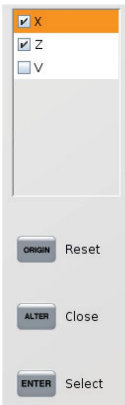
Utiliser les touches curseurs pour mettre un axe en surbrillance, et appuyer sur **[ENTER]** pour activer/désactiver son affichage. L'affichage des positions montrera les axes cochés. Appuyer sur **[ALTER]** pour fermer le sélecteur d'affichage d'axe.
