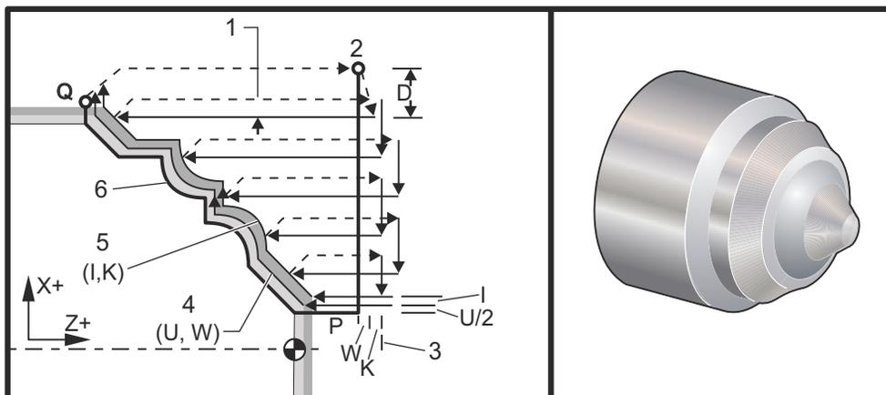
Questo ciclo fisso sgrossa il materiale su di un determinato pezzo, quando si conosce la forma del pezzo finito. Definire la forma di un pezzo programmando la traiettoria dell'utensile finito, e usare il blocco G71 PQ. Qualsiasi comando F,S o T sulla linea G71 o in vigore al momento del G71, viene usato in tutto il ciclo di sgrossatura G71. Normalmente, una chiamata G70 alla stessa definizione del blocco PQ si utilizza per la finitura della sagoma.
