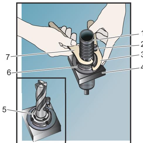
1. Inserire la trivella dell'utensile nel dado ER-AN. Infilare il dado nel dado di alloggiamento della pinza.
