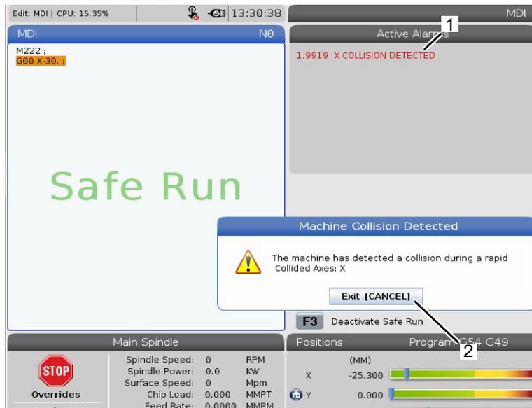
Quando viene rilevato un arresto anomalo, tutto il movimento viene arrestato, viene generato un allarme [1] e un pop-up [2] in modo che l'operatore sappia che è stato rilevato un incidente e l'asse su cui è stato rilevato. Questo allarme può essere cancellato da [RESET].
