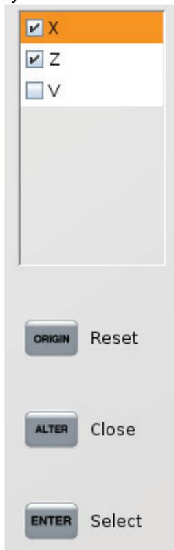
Utilizzare le frecce per evidenziare un asse, e premere **[ENTER]** per passare alla modalità on e off sul display. Le posizioni nel display mostreranno gli assi che presentano una spunta. Premere **[ALTER]** per chiudere il selettore dell'asse nel display.
