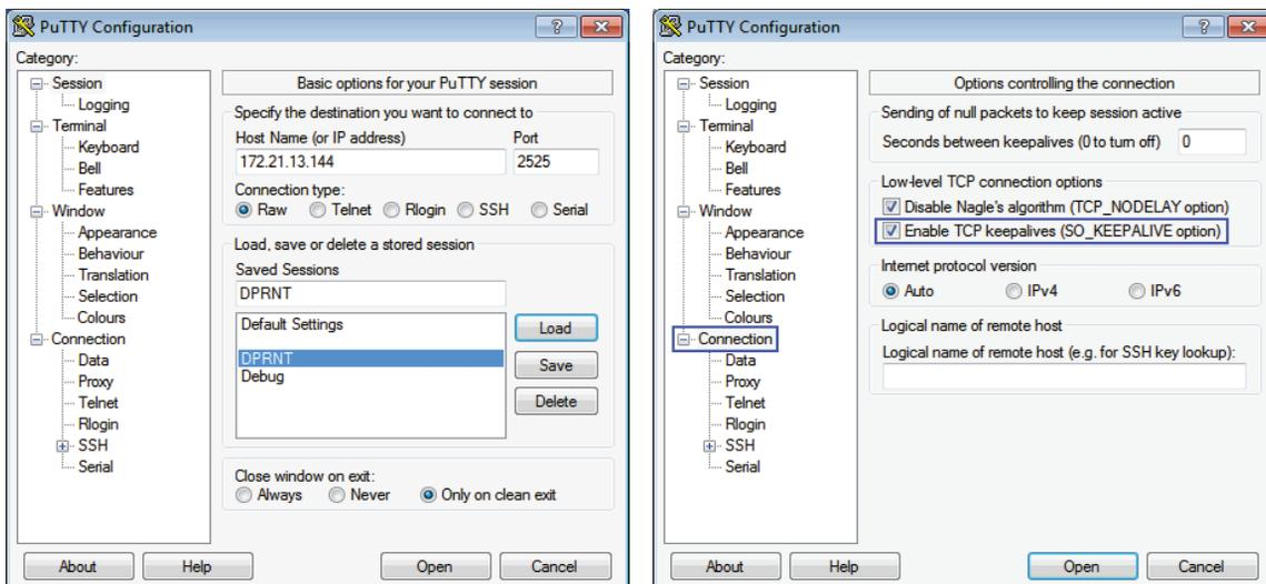
Per controllare la connessione, digitare “ping” nella finestra del PUTTY terminal e premere Invio. La macchina invia un messaggio pingret se la connessione è attiva. Si possono stabilire fino a (5) connessioni simultanee.
