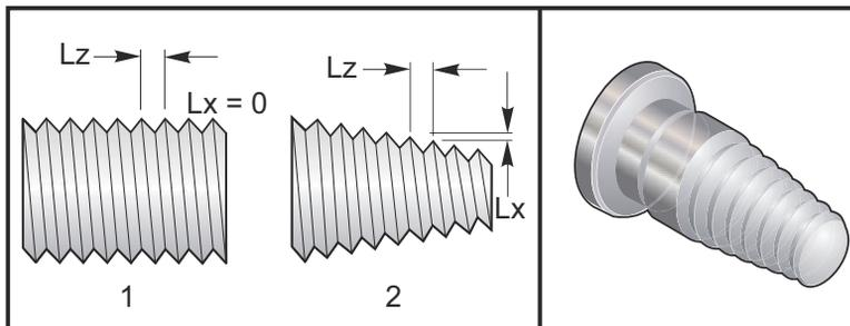
G32 è diverso dagli altri cicli di filettatura perché la conicità e/o il passo possono variare continuamente durante tutta la filettatura. Inoltre, non c'è alcun ritorno automatico in posizione alla fine dell'operazione di filettatura.
