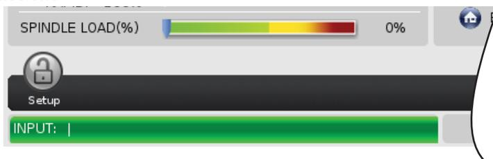
La barra di immissione è la sezione di inserimento dati situata nell'angolo inferiore sinistro della schermata. Qui appaiono i dati immessi man mano che vengono digitati.
