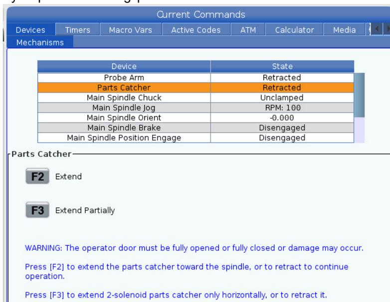
L'opzione **Parts Catcher** in **Devices** permette di **Extend** e **Retract** il raccoglipezzi. Lo sportello deve essere completamente chiuso.
