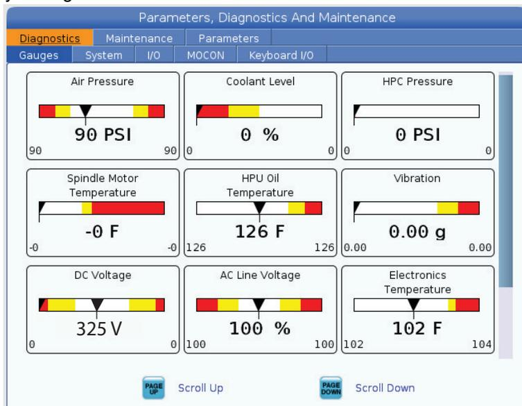
Questo display mostra velocemente le informazioni sui vari stati della macchina, incluso pressione dei fluidi, tensioni e temperature dei componenti. Premere il tasto **[PAGE DOWN]** per scorrere e vedere più manometri.
