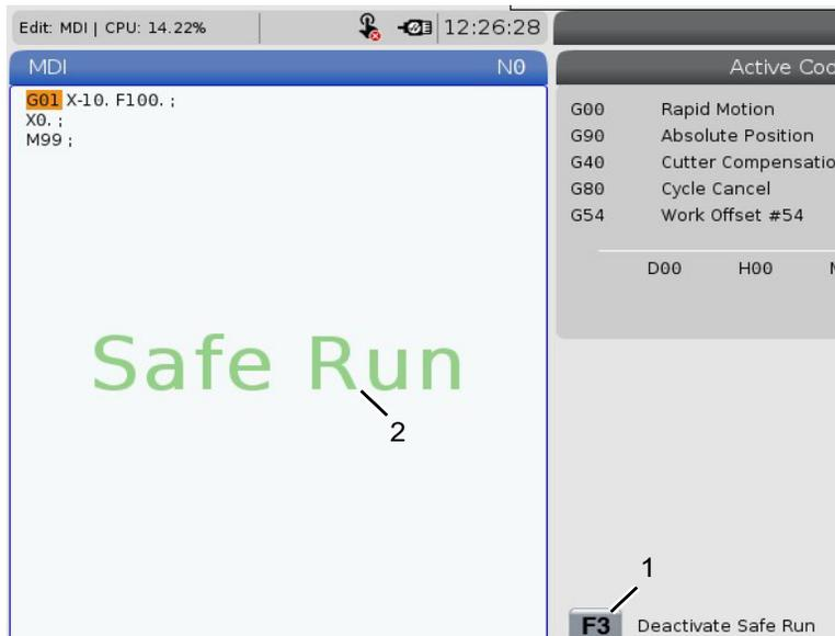
Se la macchina supporta la funzione Corsa di sicurezza, verrà visualizzata una nuova icona in MDI con il testo *F3 Activate Safe Run* [1]. Premere **[F3]** per attivare/disattivare la Corsa di sicurezza. Lo stato Corsa di sicurezza attivo è indicato da un contrassegno [2] nel pannello del programma.
