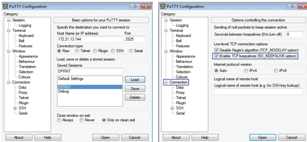
Per controllare la connessione, digitare `?Q100` nella finestra del PuTTY terminal e premere Invio. Se la connessione è attiva, il controllo della macchina risponde con *SERIAL NUMBER, XXXXXX*, dove *XXXXXX* è il numero di serie attuale della macchina.
