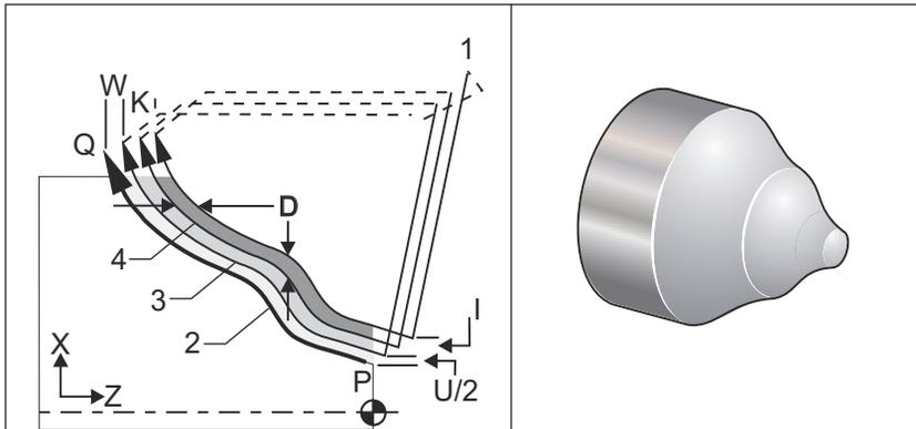
Il ciclo fisso G73 può essere usato per la sgrossatura di materiale preformato, come ad esempio pezzi fusi. Il ciclo fisso assume che il materiale è stato rimosso o che manca una distanza conosciuta dalla traiettoria utensile programmata PQ.
