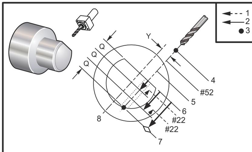
Note di programmazione: Se si specificano I, J, e K, viene selezionata una modalità di funzionamento differente. Il primo passaggio taglierà il valore di I, ogni taglio successivo sarà ridotto di J e la profondità di taglio minima sarà K. Non usare un valore Q quando si programma con I, J, e K.
