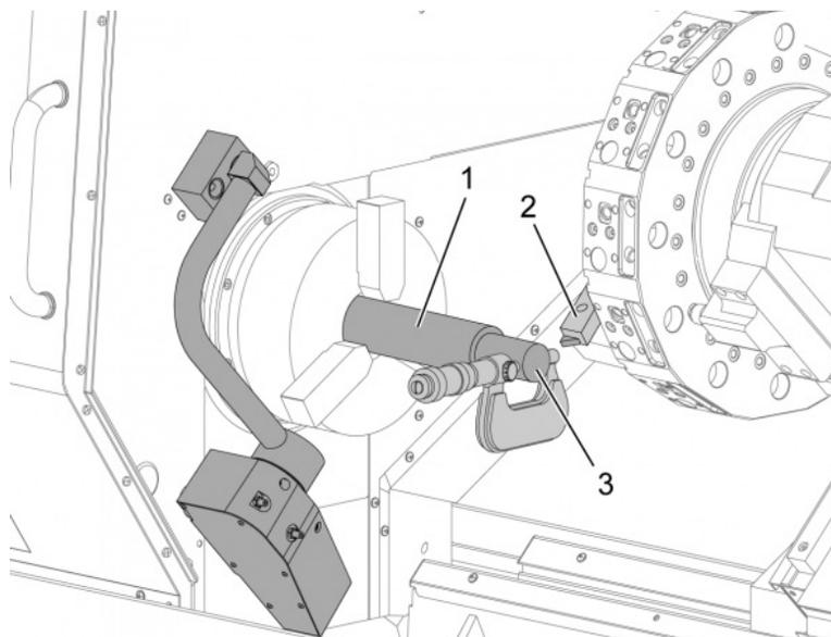
Installare l'utensile di tornitura OD nella stazione utensile 1 [2] della torretta degli utensili.
