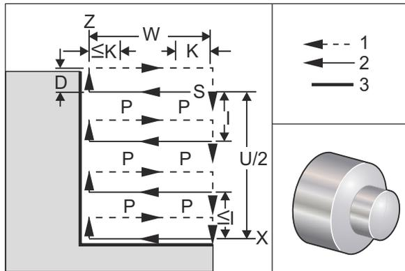
Il ciclo fisso G74 può essere usato per scanalature sulla faccia di un pezzo, foratura profonda o tornitura.
