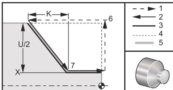
I tagli di sfacciatura finale diritti sono eseguiti specificando  $X$ ,  $Z$  e  $F$ . Aggiungendo  $K$  si taglia una faccia conica. La misura della conicità dipende dal target. In altre parole, si aggiunge  $K$  al valore di  $X$  sul target.
