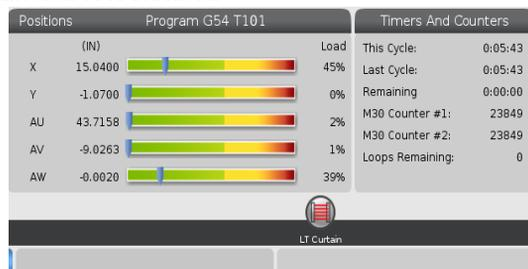
Quando il fascio di luce della barriera è ostruito, la macchina entra in una condizione di sospensione della barriera fotoelettrica e sullo schermo compare l'icona della barriera fotoelettrica. L'icona scomparirà quando il fascio non è più ostruito.
