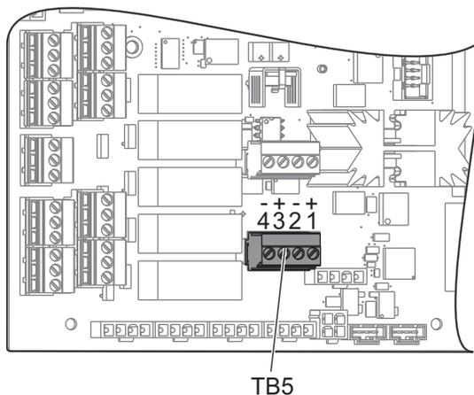
I dispositivi connessi a questi ingressi devono essere dotati della propria alimentazione. Quando un dispositivo applica 10-25 V tra i poli 1 e 2, l'ingresso 100 bit (Macro #11100) cambia da 1 a 0. Quando un dispositivo applica 10-25 V tra i poli 3 e 4, l'ingresso 101 bit (Macro #11101) cambia da 1 a 0.
