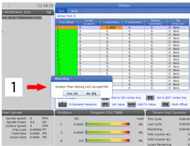
Premere **[OFFSET]** una o due volte per andare al display TOOL GEOMETRY.
