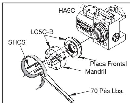
**HA5C** – A unidade aceita colares e colares passo padrão 5C. Ao colocar os colares, alinhe a passagem da chave no colar com a cavilha no interior do fuso. Empurre o colar e rode a barra de tracção para a direita até o colar estar devidamente apertado.
