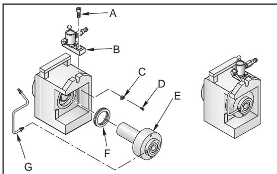
Para instalar o AC25, instale a nova porca do fuso (Elemento F), lingueta de bloqueio (Elemento C) e FHCS (Elemento D). Introduza o tubo do AC25 montado (Elemento E) na traseira do fuso do HA5C e enrosque o corpo principal na traseira do fuso. Aperte com uma chave de colar a, aproximadamente, 30ft-lbs. Instale o conjunto de válvulas (Elemento B) no topo do HA5C,
