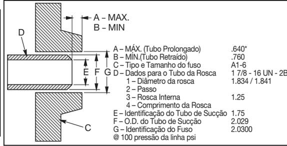
Tubo de tracção para as dimensões do fuso (esticado/retraído)
