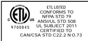
Todas as máquinas de ferramentas CNC da Haas têm a marca Listada ETL, certificando que estão conformes com a Norma de Electricidade NFPA 79 para a Maquinaria Industrial e a equivalente canadiana, CAN/CSA C22.2 N.º 73. As marcas listadas ETL e cETL foram atribuídas a produtos que passaram com sucesso nos testes da Intertek Testing Services (ITS), uma alternativa aos Underwriters' Laboratories.
