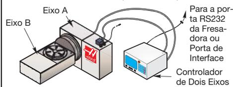
3. Passe os cabos sobre a traseira da placa metálica da fresadora e instale a abraçadeira de cabo. A placa de fundo do conjunto do fixador deve ser retirada e removida antes da montagem do fixador à máquina de desbaste. Monte o fixador à máquina de desbaste conforme a ilustração.
