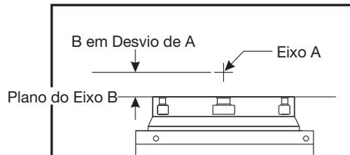
1. Rode o eixo A até que o eixo B esteja vertical. Instale um comparador no fuso da máquina (ou noutra superfície isolada do movimento da mesa) e encoste à face do disco. Coloque o comparador a zero.
