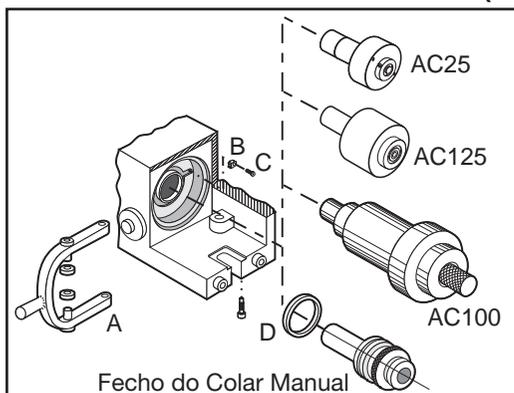
O fecho de colar A6AC aparafusa-se à parte traseira do HRT A6 (Ver a ilustração que se segue). A barra de tracção e os adaptadores do colar são concebidos para se conjugarem com o nariz do fuso Haas A6/5C. Os A6/3J e A6/16C opcionais podem ser adquiridos num distribuidor local de peças. Uma falha no seguimento das instruções de instalação do A6AC pode resultar em falha da chumaceira de impulso.
