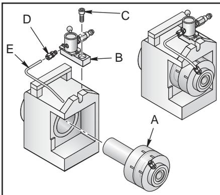
Insira, cuidadosamente, o tubo do AC125 montado (Elemento A) na traseira do fuso HA5C e aparafuse o corpo principal na traseira do fuso.
