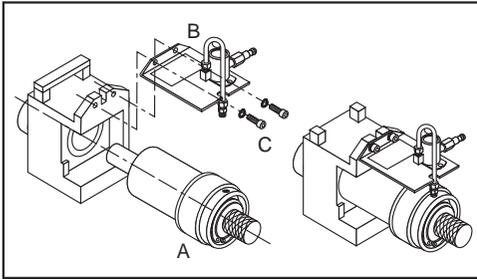
Para instalar o **AC100**, monte as braçadeiras de latão com a válvula e o anel de deslize conforme ilustrado na figura abaixo. Ao montar as braçadeiras, certifique-se de que estas estão bem apertadas e paralelas à válvula. Instale a válvula no suporte com 10-32 x 3/8" BHCS. Aparafuse o suporte à traseira do cabeçote de indexação com 1/4-20 x 1/2" SHCS e anilhas de pressão de 1/4".
