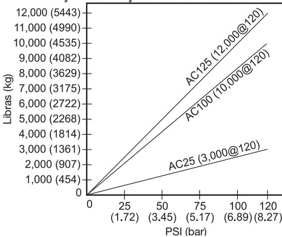
O **AC25** é um tampão do tipo sem orifício transversal que segura as peças usando a pressão de ar, que fornece até 3000 libras de força de aspiração, dependendo da pressão de ar fornecida. A unidade fornece .03" de movimento longitudinal, assim as variações de diâmetro até .007" podem ser fixadas com segurança e sem necessidade de reajuste.
