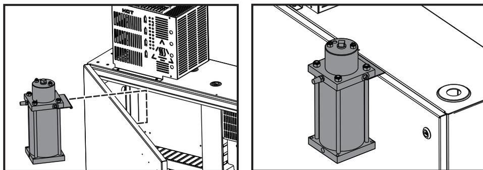
Instale o(s) impulsor(es) do travão na parte posterior da porta da cabina de controlo abrindo a porta, segurando o(s) impulsor(es) no cimo da porta, depois fechando a porta da cabina de controlo.
