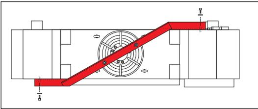
TR310: Retire os parafusos e anilhas (4) 1/2-13. Retire a porca em T (2) do disco rotativo.
