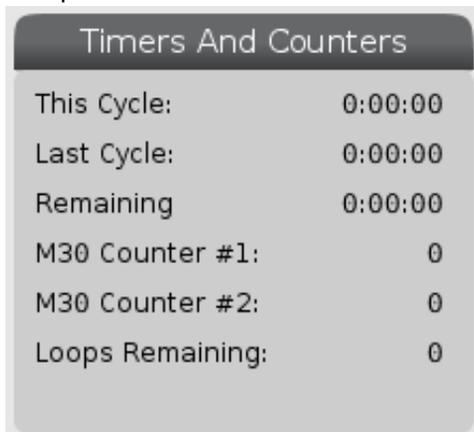
В разделе таймеров этого экрана отображается информация о времени цикла (текущий цикл, последний цикл и остаток).
