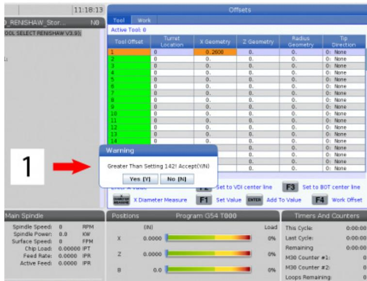
Нажмите [**OFFSET**] один или два раза, чтобы перейти к экрану **TOOL GEOMETRY**.
