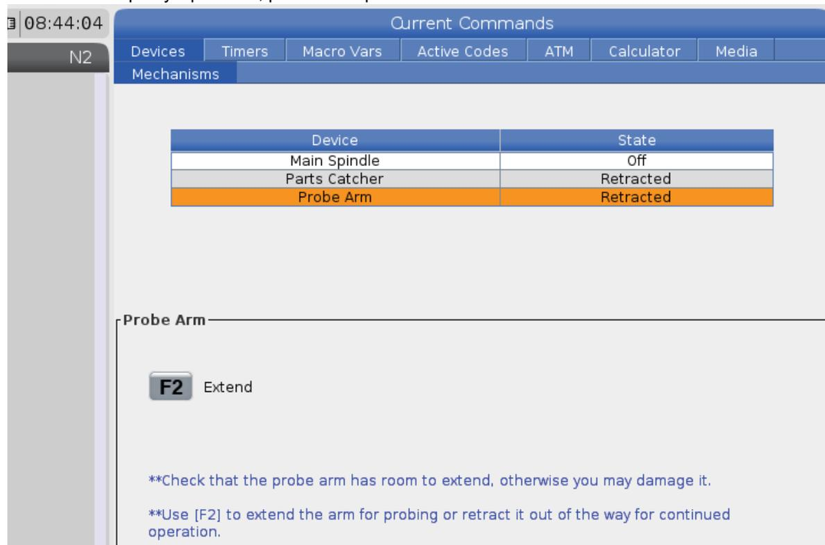
Опция **Probe Arm** в **Devices** позволяет вам **Extend** (выдвигать) и **Retract** (отводить обратно) рычаг измерительной головки. Дверь должна быть полностью открытой или полностью закрытой.
