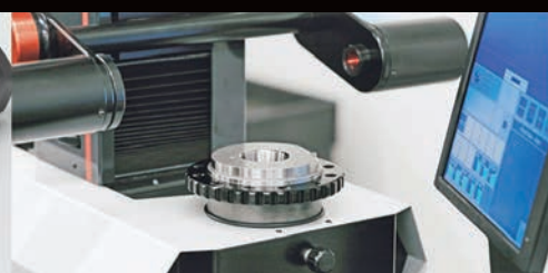
WYMIANA NARZĘDZI Zestawy do wstępnego ustawiania narzędzi i maszyny z z pasowaniem skurczowym
