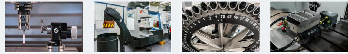
SISTEMA DE SONDAGEM SEM FIOS      SISTEMAS DE REMOÇÃO DE LIMALHA      COMPUTADOR DE FERRAMENTA DE 70 BOLSAS      DISPOSITIVO DE APERTO
