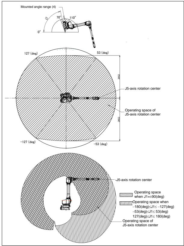
Fig. 3.7 (d) Operating space for mounted angle range (4)  $(70^{\circ} < \phi < 110^{\circ})$  (M-710*i*C/20L)
