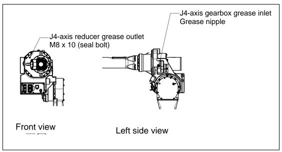
Fig. 8.3.2.1 (d) Replacing grease of the J4-axis gearbox
