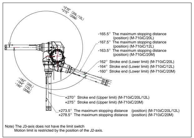
Fig. 3.3 (d) J3-axis motion limit
