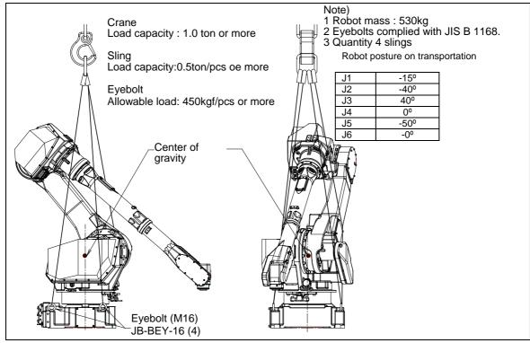
Fig. 1.1 (d) Transportation using a crane (M-710iC/20M)
