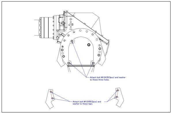
Fig. 6.2 (d) J3-Axis movable mechanical stopper
